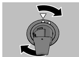
Если фильтры установлены неправильно, это может повлиять на результат мойки. Обратите внимание, что запрещено эксплуатировать посудомоечную машину со снятыми фильтрами!
