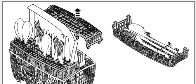
Крышку корзины для столовых приборов можно снять и использовать, например, в качестве дополнительной корзины, разместив в ее в верхней корзине (см. выше).
