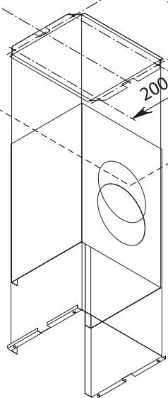
**IT** - Installazione valvola di non ritorno (6). Montaggio tubo aspirazione (7). Assemblaggio camino ed estensione (8).
