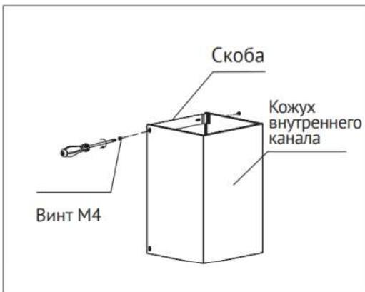
4. Прикрепите фиксирующую скобу к внутреннему телескопическому коробу винтами M4.
