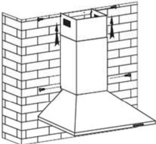
8. Выдвиньте внутреннюю часть короба на высоту саморезов, подвесьте короб на саморезы за фиксирующую скобу. По отверстиям скобы отметить и просверлить 2 отверстия диаметром 8 мм и глубиной 75~85 мм. Далее следует выровнять фиксирующую скобу с отверстиями и затянуть саморезами 5x60.
